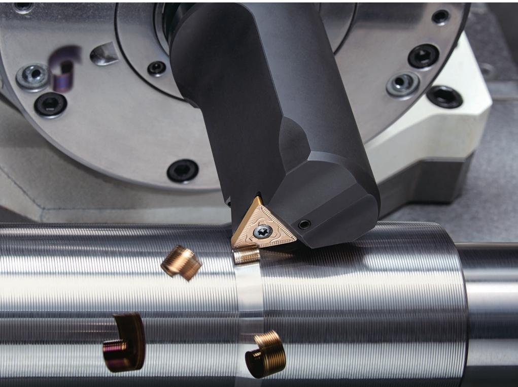
1 Mit der Werkzeugtechnologie AddY-axisTurn können Anwender sämtliche Außen- und Plandrehbearbeitungen in allen Richtungen durchführen © Tungaloy
